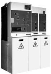
Tablero aislado en gas SF<sub>6</sub> modelo Flusarc 36 kV para redes de distribución con medio de extinción de arco eléctrico en vacío
