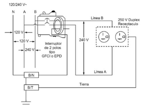
Esquema de conexión de multicircuitos monofásicos.
