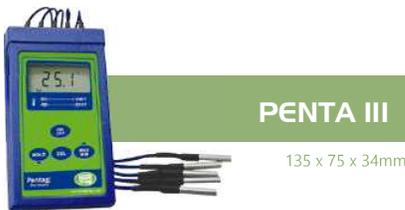
Termómetro portátil que monitorea e indica la temperatura en 5 puntos distintos. Presenta recurso de registro de las temperaturas mínimas y máximas, función HOLD (detenido de indicación de las indicaciones instantáneas, mínimas y máximas), medición de subenfriamiento y sobrecalentamiento e indicación de las temperaturas media y diferencial.
